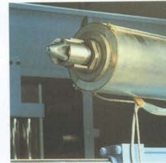
Ispezione del puntale facile ed agevole Easy inspection of screw tip assembly Inspection facile de l'embout de vis Inspección de la puntera fácil y rápida
